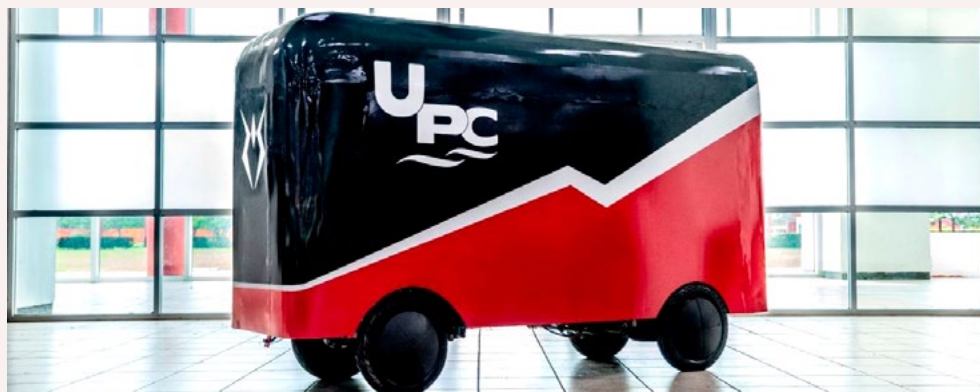
Imagen 4. Prototipo funcional del vehículo eléctrico autónomo “Obsidian”, optimizado para la logística urbana de última milla. Fuente: Elaboración propia.
