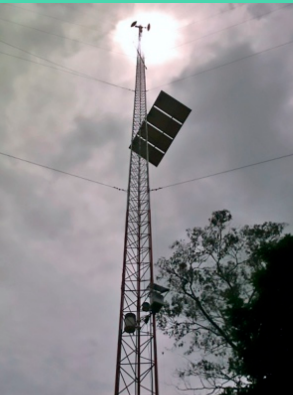
Figura 1. Estación meteorológica automática instalada por la UJAT y el CCGSS en el Parqueológico del Municipio Emiliano Zapata.
